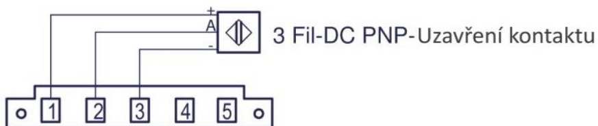
Schéma zapojení pro indukční bezdotykový spínač
